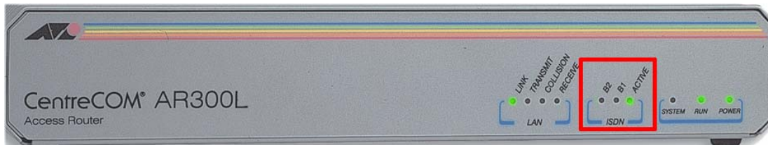
Ενδεικτική φωτογραφία δρομολογητή Allied Telesyn. Η ένδειξη Active για το ISDN αναμμένο
