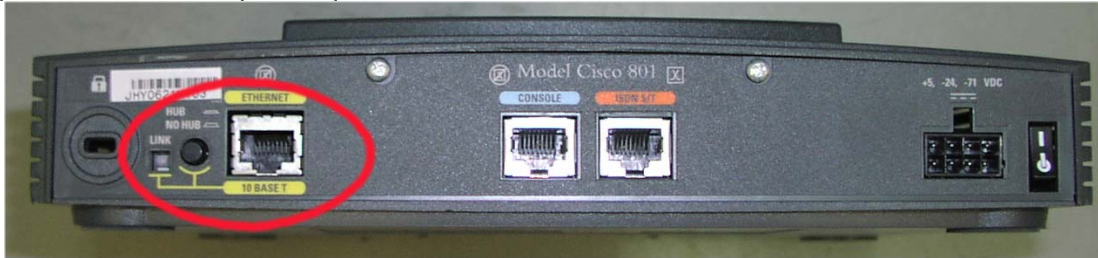
Ενδεικτική φωτογραφία δρομολογητή CISCO 801 με διακόπτη για HUB / NO HUB
